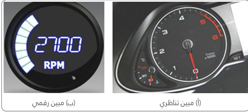
الشكل (٩) : بعض أشكال مبيّنات قياس سرعة المحرك.
