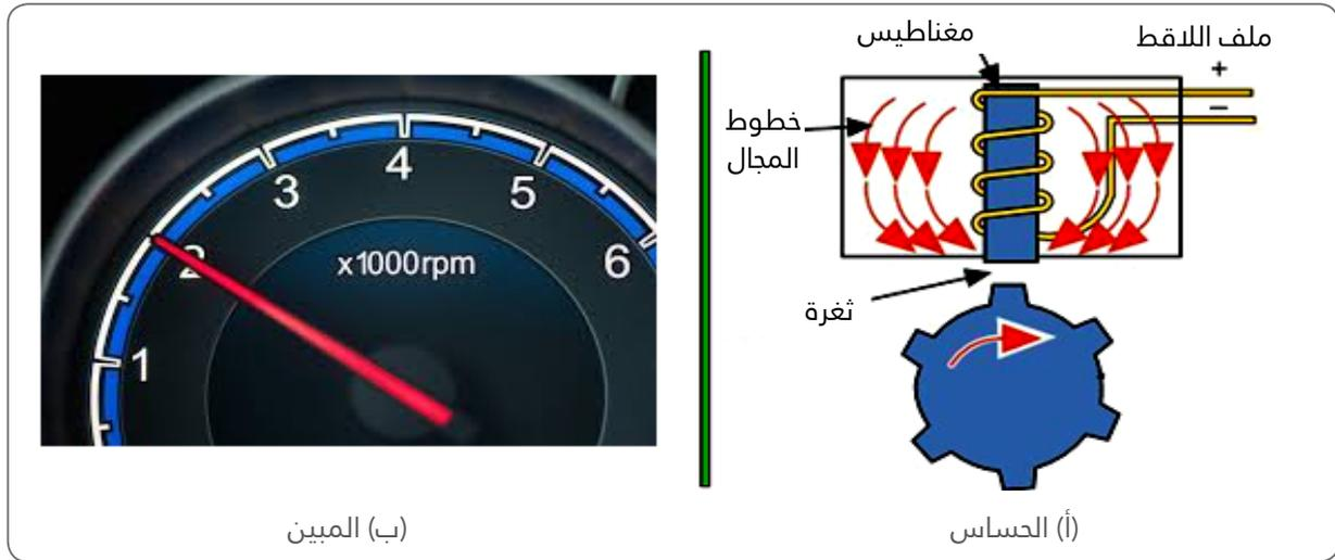
الشكل (٨): مبين قياس سرعة المحرك.
